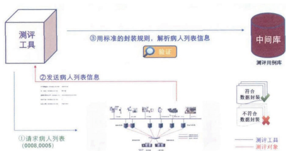
图2 PACS 系统 DICOM 标准符合性测试流程
